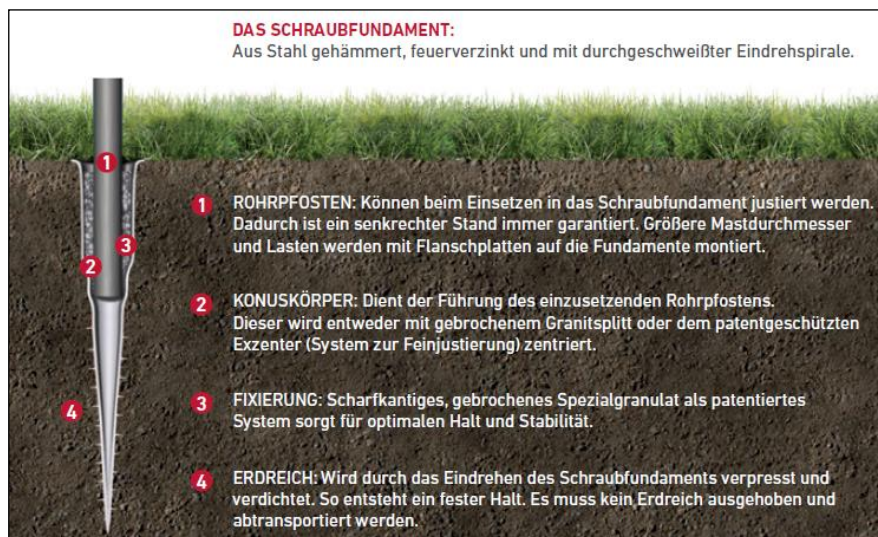
Abb. 1: KRINNER Das Schraubfundament (Prinzipskizze, Quelle: Broschüre Sortimentsübersicht)
