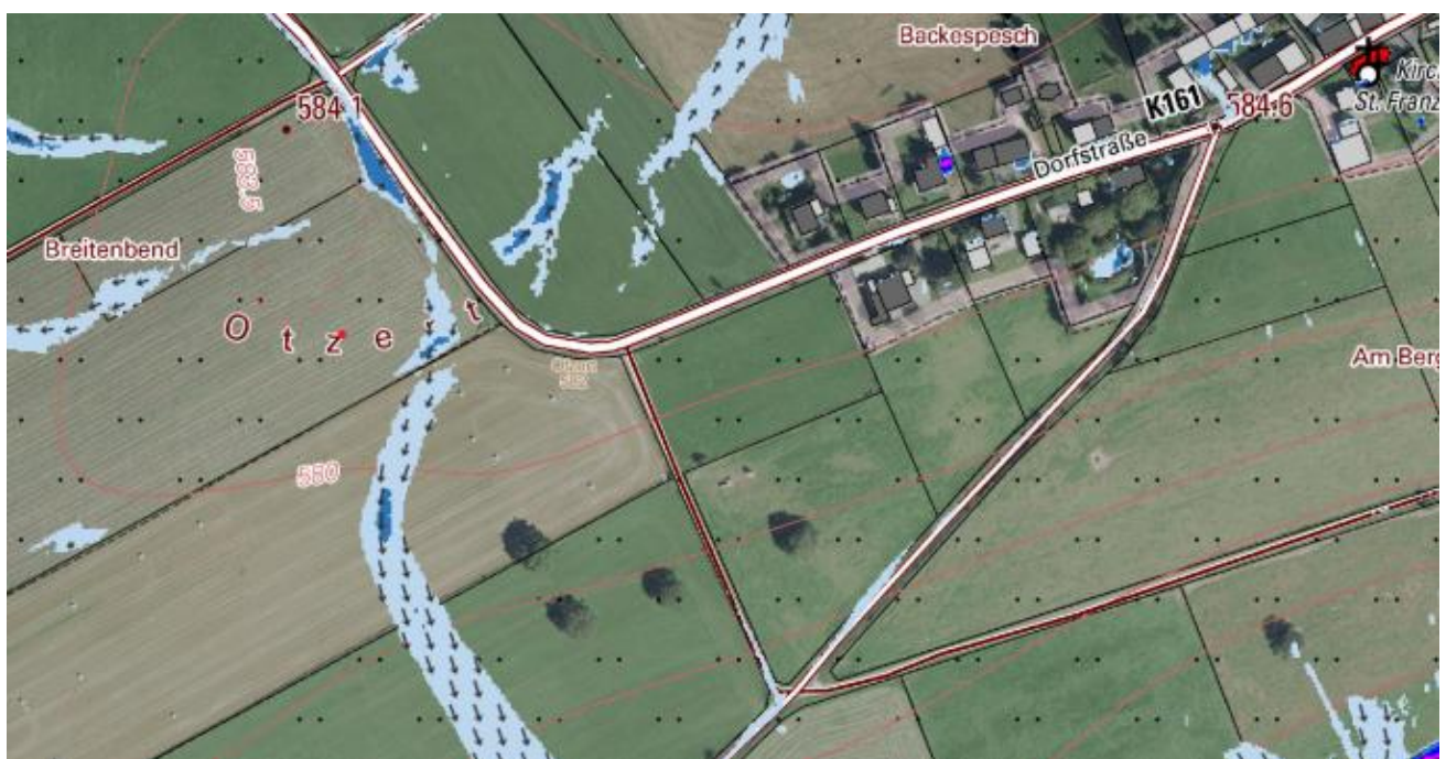
Abbildung 1: Auszug aus der Starkregengefährdungskarte; Wassertiefen und Fließrichtung für SRI 10
