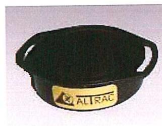
Foto 4: Aufnahme eines Kernspurdetektors
