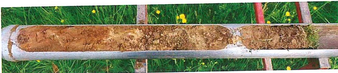
Foto 5: Aufnahme des Bohrprofils Ra1
