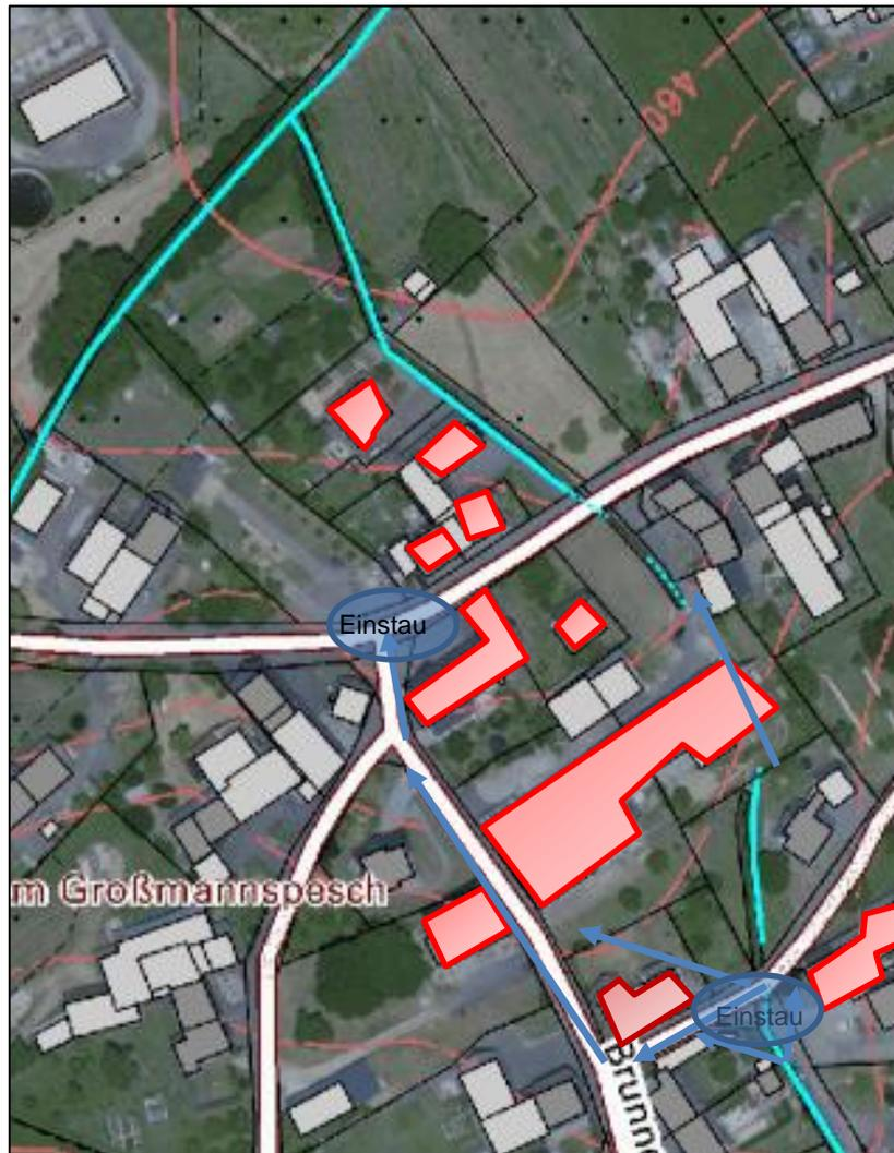
Abbildung 58: Luftbild der Tiefenlinie im Ort bis zur Mündung in den Büdesheimer Bach mit Darstellung der Fließwege bei Hochwasser und besonders betroffene Objekte (rot bzw. tiefrot)
