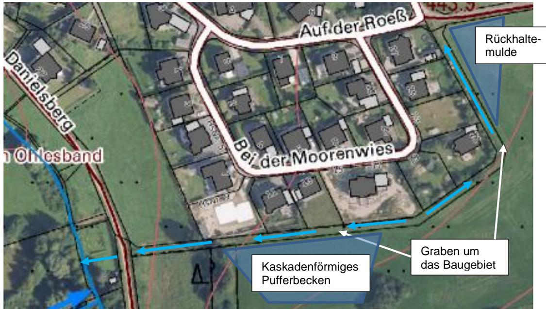
Abbildung 86: skizzenhafte Darstellung des Maßnahmenvorschlages an der „Moorenwies“
