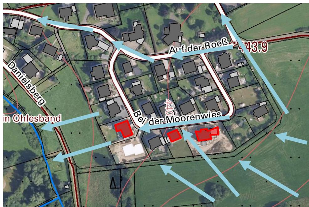
Abbildung 75: Luftbild mit DTK 5 Baugebiet „Bei der Moorenwies“ mit Darstellung der Fließwege (blaue Pfeile) und besonders gefährdete Objekte (rot markiert) (DATASCOUT)
